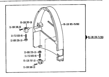
Blasvorrichtung Blower Dispositif à jet d'air Eyector de aire
